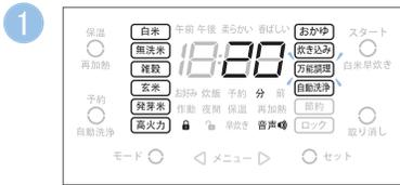
圧力ロックハンドルを「**θ**」(ロック)の方向に回し、メニュー/選択ボタンを押して万能調理を選択します。
