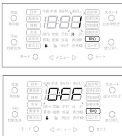
1. 待機状態で、モードボタンを7回押すと、自動節電機能モードになります。モードボタンを長押しすると設定モードになります。
