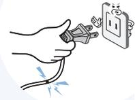
定格15A以上、交流100V以上の専用コンセントをお使いください。一つのコンセントに多数の電源プラグを同時に使わないでください。
