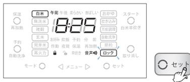
1. 炊飯、予約、保温/再加熱中や待機状態でセットボタンを3秒以上押すと、作動ロックが設定されます。
